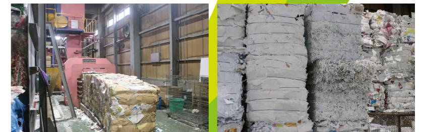
専用機で分別または破碎した古紙を圧縮・梱包します。梱包を終えた古紙は工場内でストックして出荷・詰め込み作業を待ちます。
