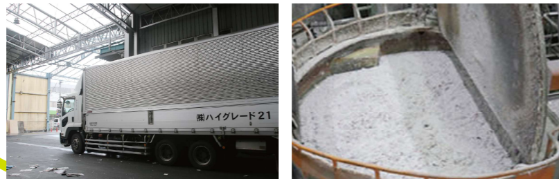
風雨を避けることのできる屋内構造のヤード内で積み込み作業を行います。出荷した古紙は製紙工場で溶解し、リサイクル・再資源化します。
