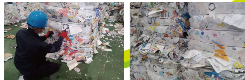
圧縮・梱包した古紙 ( 製紙原料製品 ) に不純物が含まれていないか、出荷前にスタッフの目視による全品自主検査を実施しています。
